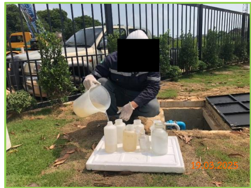
บ่อบักน้ำหลังผ่านระบบบำบัดน้ำเสีย
