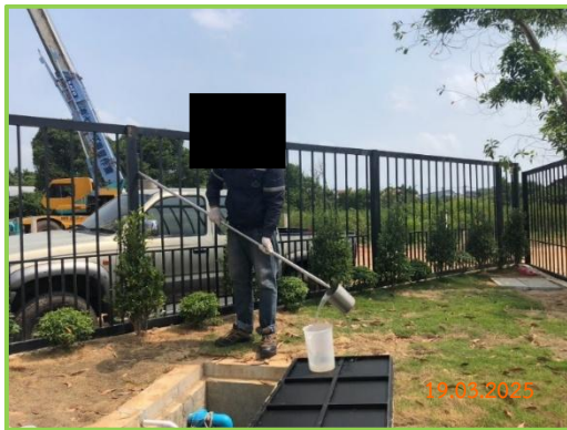
บ่อบักน้ำหลังผ่านระบบบำบัดน้ำเสีย
